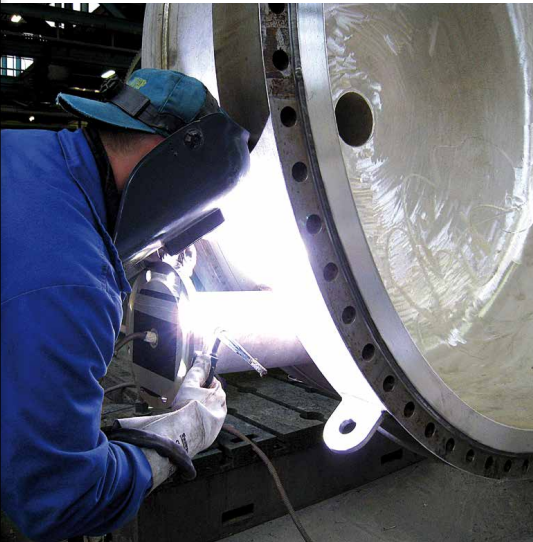
WIG-Schweißer in Aktion an einem Prozessbehälterboden, dessen Innenfläche mit 3 mm dicker Silberplattierung versehen ist.
